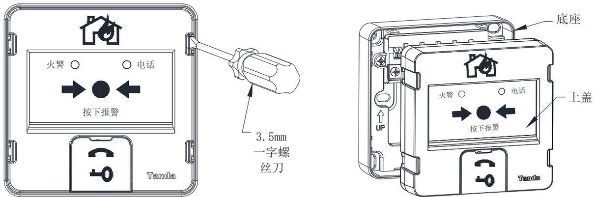
图3 报警按钮拆卸示意图
