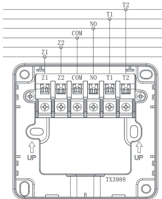
图4 报警按钮接线示意图
