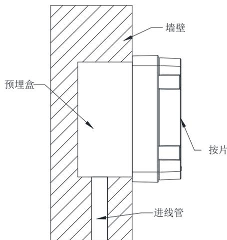
图 2 报警按钮安装示意图
